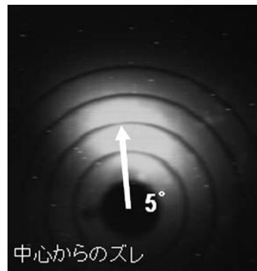
図 3 図 2 の装置で観測された典型的な FEM パターン例。ビーム中心は 5 度、軸方向からずれている。
