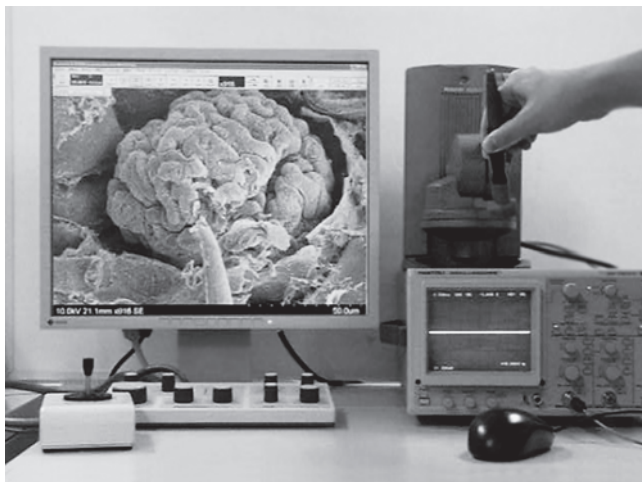
図8 リアルタイム 3D-SEM にマニピュレータを装着し、実際に利用している様子
