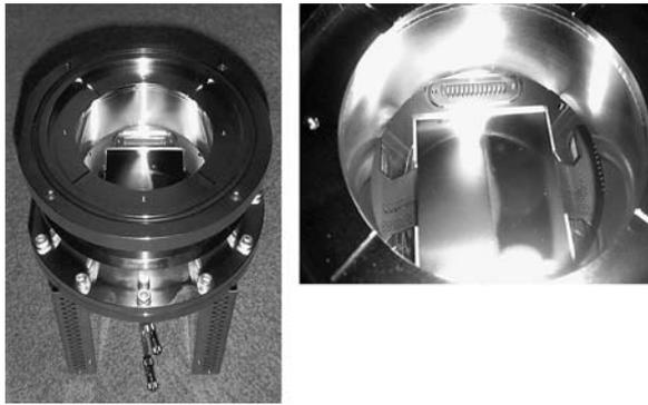
図12 直接電子検出 CCD カメラ。画素ピッチ  $15\ \mu\text{m} \times 15\ \mu\text{m}$ 、画素数  $4096 \times 4096$  ( $2048 \times 4096$  CCD を2枚併設)。
