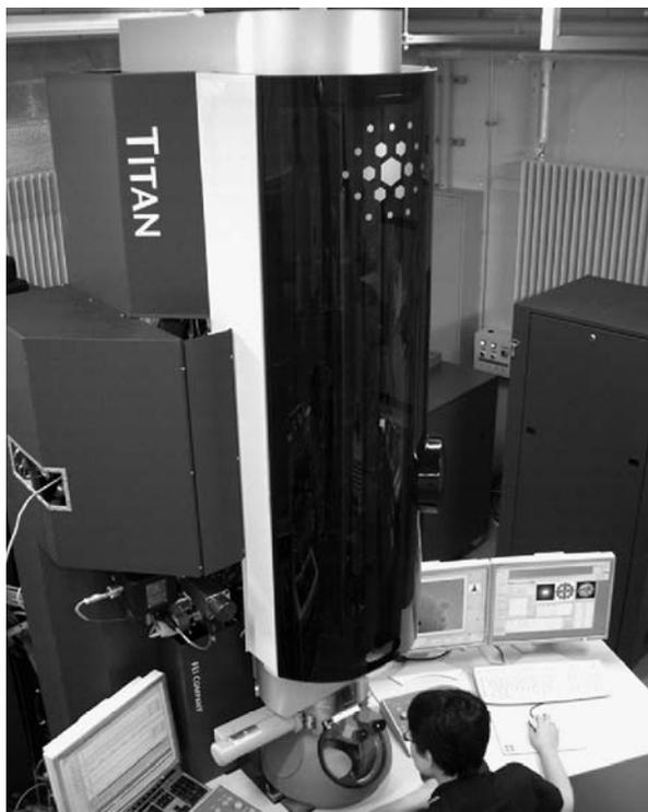
図1 対物レンズの球面収差が補正された高性能 TEM (FEI Titan 80-300) をベースにした ETEM.
