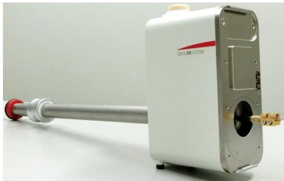
今回は、①浸漬凍結、②凍結切断／凍結切削、③クライオ SEM 観察、④EDS による元素分析を、クライオ SEM のための新型クライオトランスファーシステム（Leica EM VCT500 システム：左図）でリンクさせた初めての練習を行います。なお、参加者の持ち込み試料について、トレーニング第2日目の午後にプレリミナリーな観察でなければ対応可能な場合があります。持ち込み試料を希望する場合は、参加申し込みの際に備考欄に記載して下さい。
