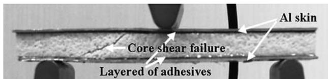
図6 曲げ加重負荷下でのセラミックス発泡体芯サンドイッチ構造の芯材の剪断破壊。
