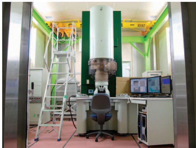
図 1 モノクロメータ付き 200 kV 原子分解能分析電子顕微鏡 (JEM-2400FCS)
