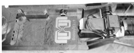
-160度に冷やされたナノチップを搭載したホルダー先端部
