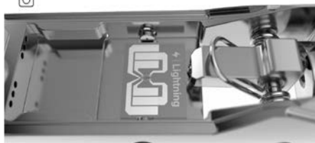
加熱バイアス印加用ナノチップを搭載したホルダー先端部
