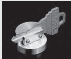
(左) 片断面 SEM 試料台 (鍵を固定した例)
