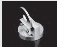
(右) 両断面 SEM 試料台 (ワッシャーを固定した例)
