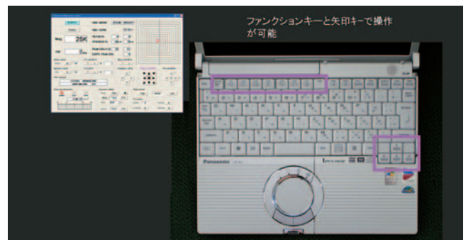
図4 主な機能をキーに割り当てて操作性を向上したノートパソコン型操作卓
