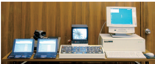
図 5 DVTS 端末を含む遠隔操作卓一式
