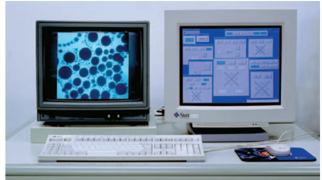
図3 操作ボタンを画面に配置した遠隔操作方法
