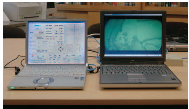
図10 ハイビジョン画像とノートパソコンにソフトをインストールした操作卓を用いた遠隔観察
