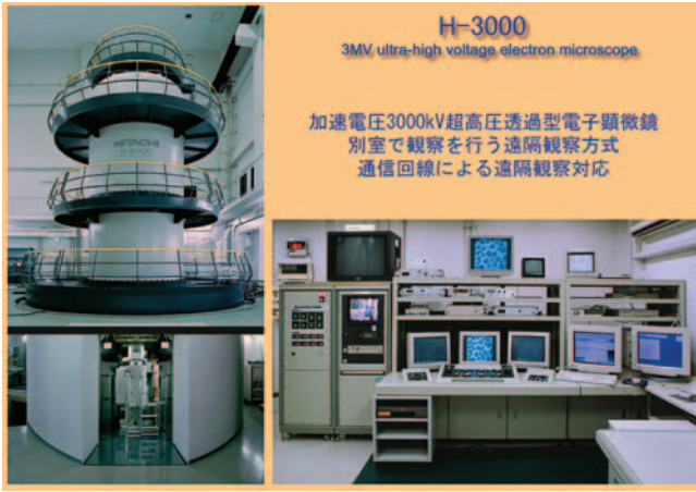
図1 H-3000型超高压電子顕微鏡と操作室
