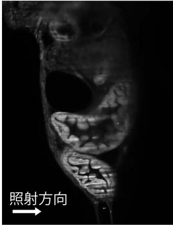
図2 メダカ稚魚の断面写真。励起光は写真中左から右に向かって照射されている。照射レンズに近い側ほど画質は鮮明で、遠ざかるほど像のにじみや照明むらが目立つ。
