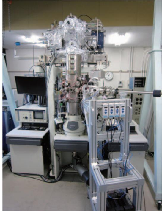
図3 スピン偏極透過電子顕微鏡の全体写真
