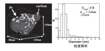
図5 電子線トモグラフィ (TEMT) による燃料電池電極触媒 微粒子の粒子径分布定量解析 <sup>16</sup>.
