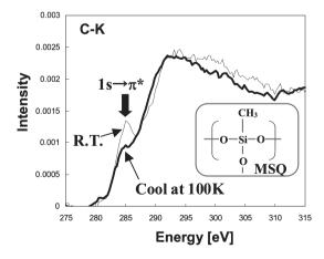
図 4 Si-O-C 系低誘電率膜の冷却 EELS 測定による,C-K 吸収端構造の変化.常温測定では,電子線ダメージにより本来存在しない C=C 二重結合由来のピーク(285 eV 付近)が出現している.
