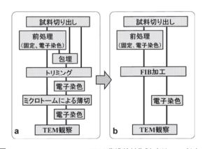
図 1 ソフトマテリアルの TEM 薄膜試料作製手順. a: 従来の 超薄切片法, b: FIB を用いたアプローチ.
