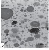
図2 酸化チタン粒子混合 ABS 樹脂の TEM 写真. a: 超薄切 片法による薄膜試料,b: FIB 法による薄膜使用.
