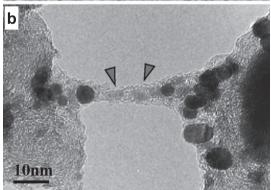
図3 Cs, Pb イオン交換染色法を用いたスルホン基(親水クラスター)部分の可視化. a:電解質ポリマー単体 (Cs イオン交換), b:燃料電池電極構造 (Pb イオン交換).
