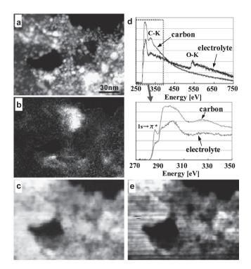
図 7 EELS スペクトルイメージングを用いた燃料電池電極の解析例。 a: HAADF-STEM 像,b: C-K 分布像,c: O-K 分布像,d: EELS 結果(坦持体と電解質構造には明瞭な差異が存在),e:  $sp^2$  分布像(担持体部分).
