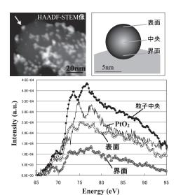
図8 燃料電池電極触媒表面〜担持体界面における局所 EELS 測定結果 (Pt-N).
