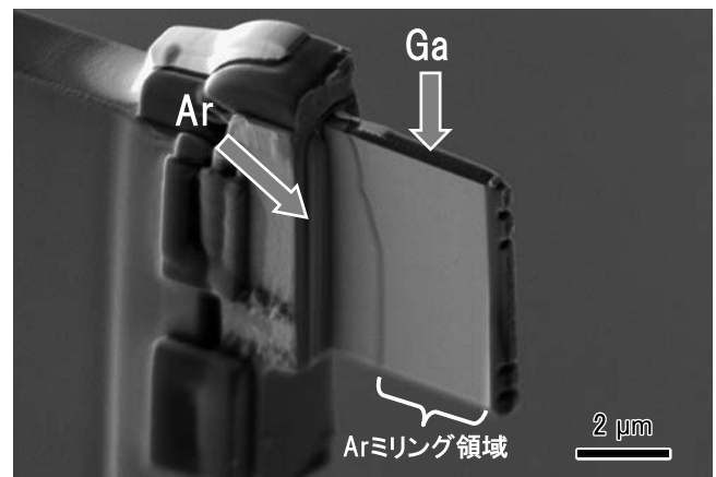
図10 トリプルビームFIBを用いて、Gaイオンビームで薄片後、Arイオンビーム照射したTEM試料のSEM像。
