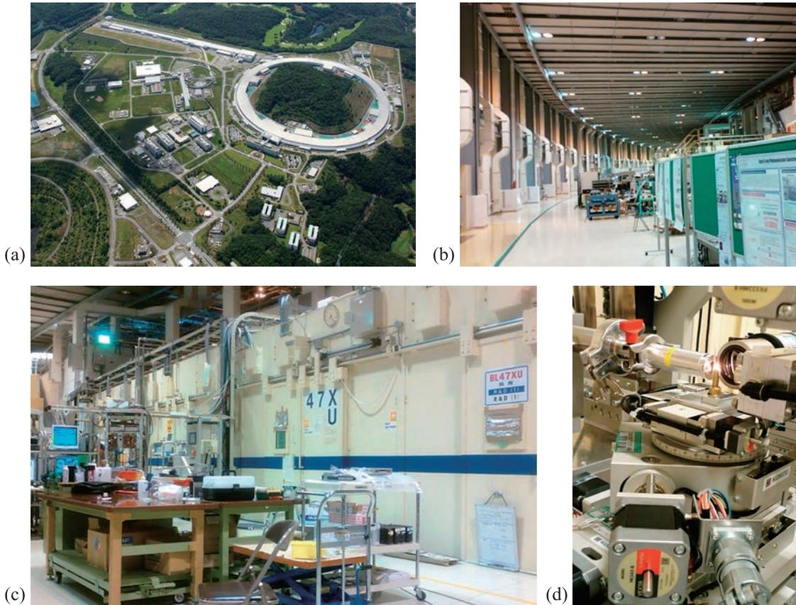
図1 放射光施設 SPing-8 での実験の様子。(a) 円環状の巨大な建物が蓄積リング棟。それに囲まれるのが三原栗山(標高341 m)。写真の提供:RIKEN/JASRI。(b) 蓄積リング棟の実験ホールに入ったところ。照明・空調・内装等の雰囲気から、どこまでも続く体育館のようである。この写真の右側にハッチがある。(c) BL47XU ビームラインの光学ハッチ(奥半分)と実験ハッチ(手前半分)。ここで図2のショウジョウバエ脳の構造を解析した。他にも多数のビームラインが配置され、多種多様な実験が行われている。(d) BL47XU 実験ハッチ内で試料を回転ステージにマウントしたところ。右奥からの照明で光っているのが試料で、測定時にはこの照明は消して、放射光 X 線を左奥から右手前に向けて照射する。
