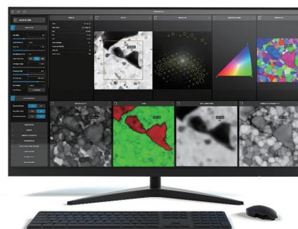
STEM 像、EDS マップと回折パターンを同時取得し、相・方位マップをほぼリアルタイムで表示している TENSOR のユーザーインターフェース画面
