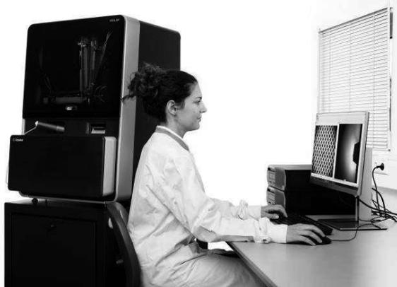
クライオ電顕用の凍結試料作製プロセスを、一つの装置に統合して完全自動化した画期的なシステムです。そこには、サンプル成膜と急速凍結に関する特許を含む高度な技術が集約されています。
