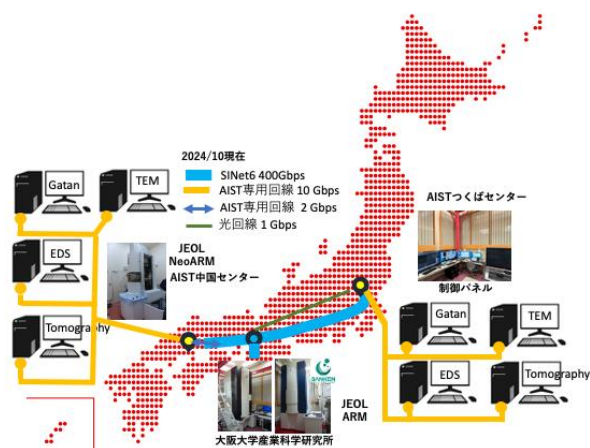
図2. AIST 材料化学領域大規模ネットワークと大阪大学-AIST との電子顕微鏡遠隔操作
